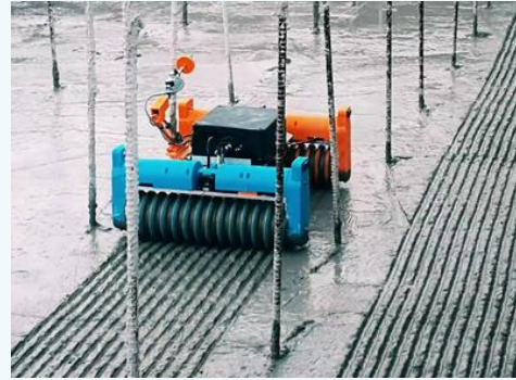
포스코 이앤씨 콘크리트 시공이음부 요철생성 로봇
